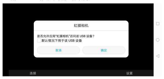
3. 点击"连接",设备进入虹膜采集状态。默认情况下,不显示虹膜图像,如要显示,可以在"设置"菜单中设置;
